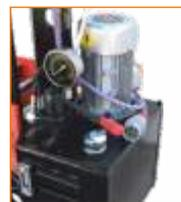
CENTRAL HIDRÁULICA CON CONEXIÓN ELÉCTRICA HOMOLOGADA
