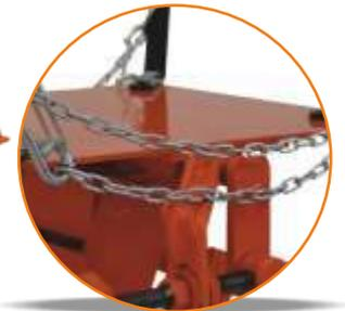
Camilla regulable en diferentes posiciones posee cadenas para sujetar la carga.
